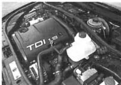
Power-Diesel: Der TDI-Motor von B&B leistet 115 PS
