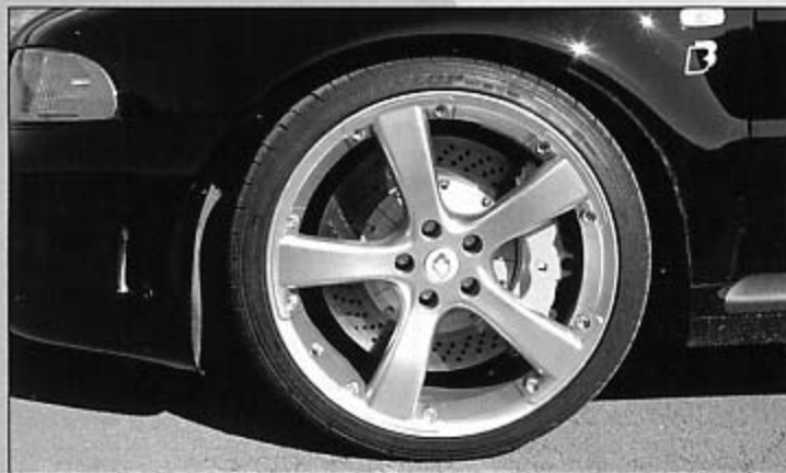
4-Kolben Bremsanlage von Porsche mit 380 mm Scheiben
