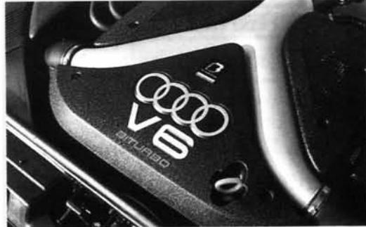
■ Undercover: Der unter der serienmäßigen Plastikabdeckung verborgene 2,7-Liter-Biturbo-Motor des B&B-Audi S4 leistet dank Elektronikoptimierung, Ladedruckanhebung und Kennfeldanpassung 310 PS
