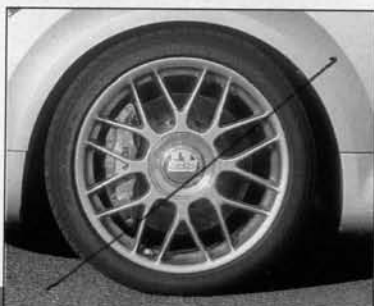
■ Hohenester setzt auf BBS-Felgen und Vier-Kolben-Bremssättel mit 330 Millimeter großen Bremsscheiben
