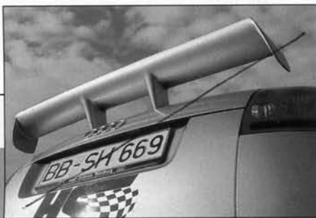
■ Der nach STW-Vorbild gestaltete Hohenester-Heckflügel vermindert den Auftrieb
