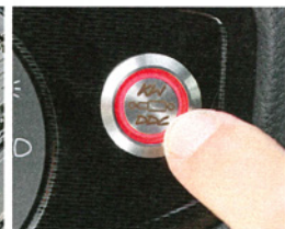
Die kleine Taste aktiviert die drei Kennlinien des grundsätzlich harten KW-Fahrwerks
