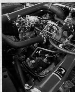
Kalte Luft: Mit gewaltigem Ladeluftkühler kommt B&B auf 120 PS
