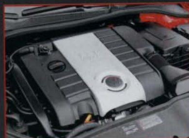
Drehfreudig: 2.0 TFSI-Maschine mit 200 PS und 280 Newtonmetern
