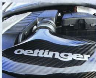
Oettinger: Es geht an den Turbo 280 PS und 400 Nm (Spitze: rund 260 km/h) bringt der andere Turbolader
