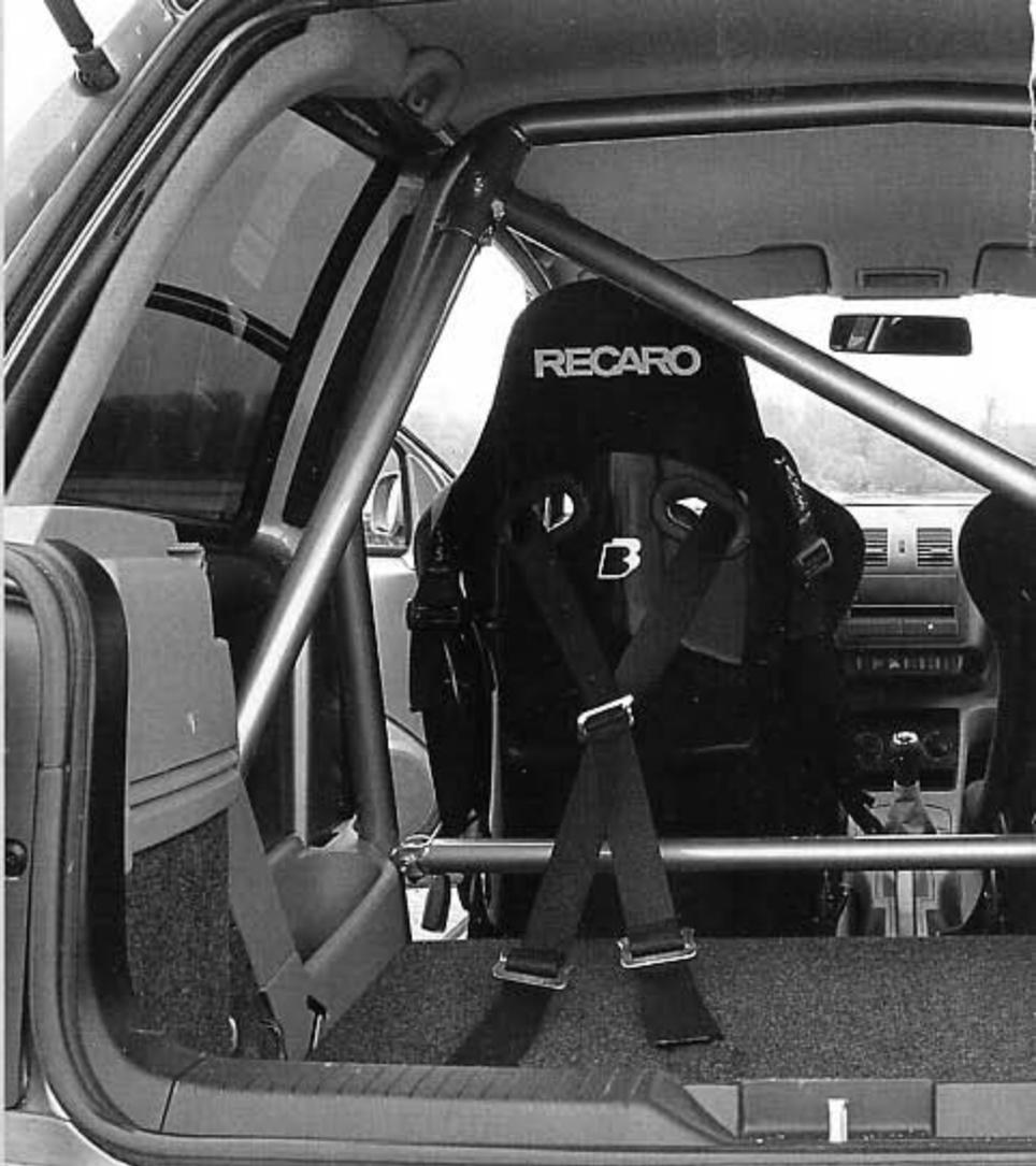
**Wolfskäfig:** Die Rohrkonstruktion sorgt neben der Sicherheit für eine weitere Versteifung der Zelle, die Fahrzeugbatterie ist für bessere Gewichtsverteilung und aus Platzgründen hinten in der Reserve- radmulde montiert
