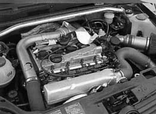
**Motor für mehr:** Der aus dem TT stammende 1.8 l Vierzylinder-Fünfventil-Turbo kommt auf 300 PS
