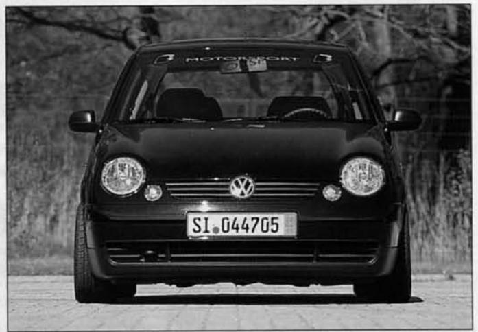
Flach gemacht - dank Gewindefahrwerk geht's bis zu 100 mm in die Knie
