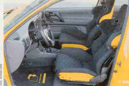
Kunststoff-Schalensitze bieten dem Piloten den nötigen festen Seitenhalt. Auch mit Hosenträgergurten zu bestücken
