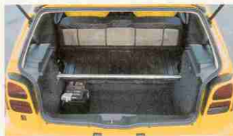
Kofferraum-Asyl: Die Batterie findet im Motorraum keinen Platz, ist im Heck links installiert
