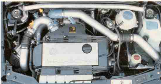
Passt millimetern genau: der von 174 auf 350 PS angefüllte VR6. Maßnahmen zu dieser glatten Leistungsverdoppelung? Alles, was technisch machbar ist
