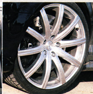
Achtkolben-Bremse: standfest, aber keine Verbesserung der Werte
